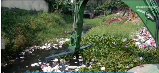
Рис. 10. Очищення мілководної зони від рослинності і сміття робочим органом «граблі»
