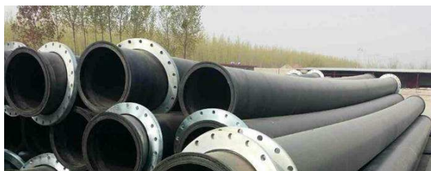
Рис. 9. Поліетиленові труби для спорудження берегового пульпопроводу
