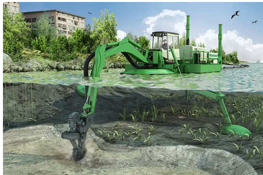
Рис. 6. Закріплення земснаряду над забоем
