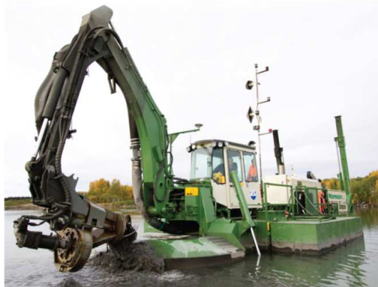
Рис. 2. Багатофункціональний земснаряд «Watermaster Classic V»
