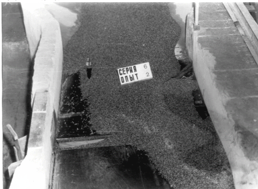
Рис. 7. Відкладення наносів в траншейній піскогравієловці
