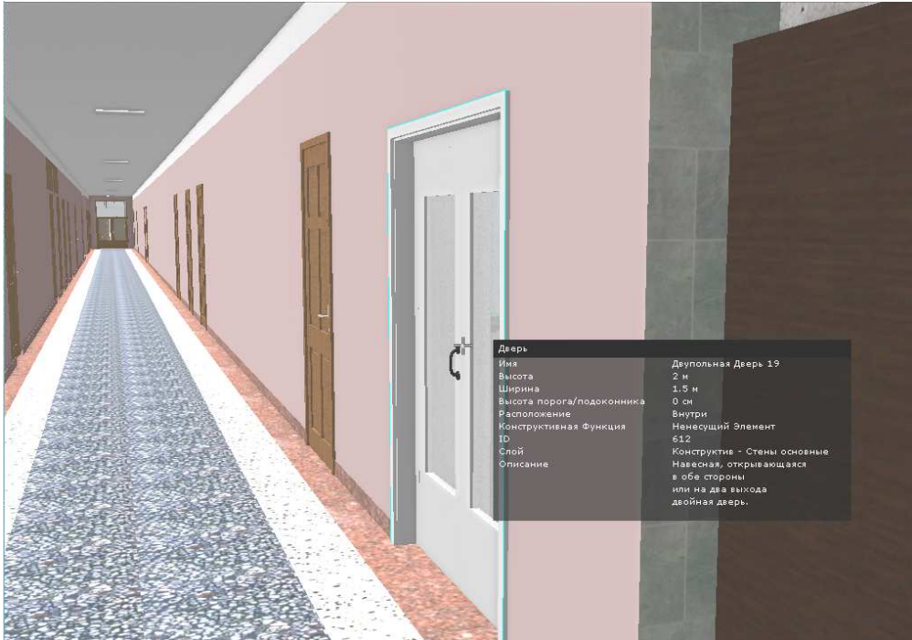
Рис. 9. Перегляд інформації про елементи моделі у BIMx
