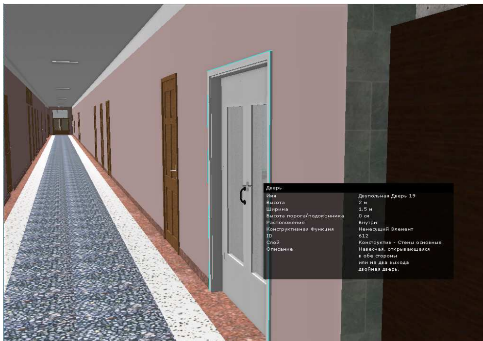
Рис. 9. Перегляд інформації про елементи моделі у BIMx
