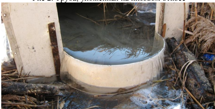
Рис 3. Измерение расходов воды в дренажной канаве
