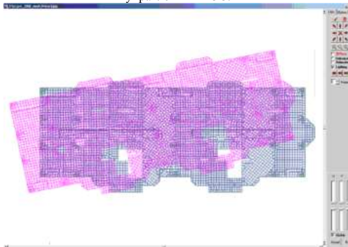
Рис.6. Крутильная форма колебаний частичной системы 1-го уровня ПК PRIS2000
