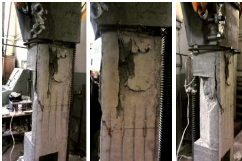
Рис. 3. Колонна 0 0 -1 после испытаний
