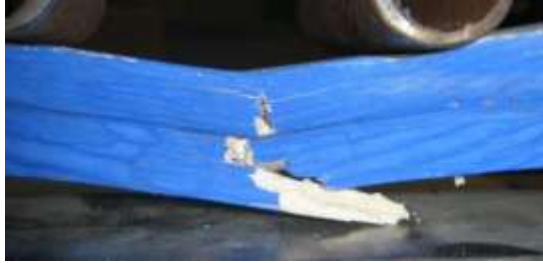
Рис.1 Разрушающая трещина в неармированном образце
