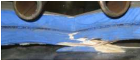
Рис.2 Разрушающая трещина в армированном образце
