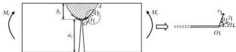
Рис. 6. Схема итерационного расчета формы выкола
