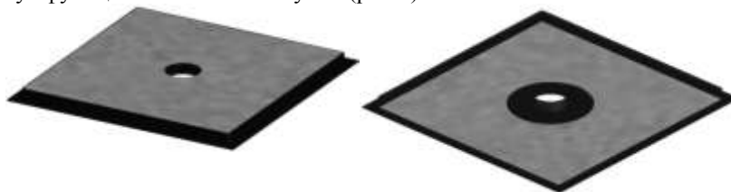
Рис. 1. Загальний вигляд залізобетонної плити зі сталевим обрамленням, зразок ПН 75-1
