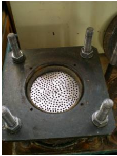
Рисунок 4 Форма циліндр з композитом IZO-РИФ готова до випробування
