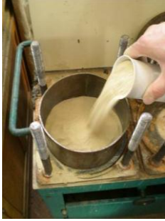
Рисунок 2 Пошарове наповнення форми циліндру композитом IZO-РИФ
