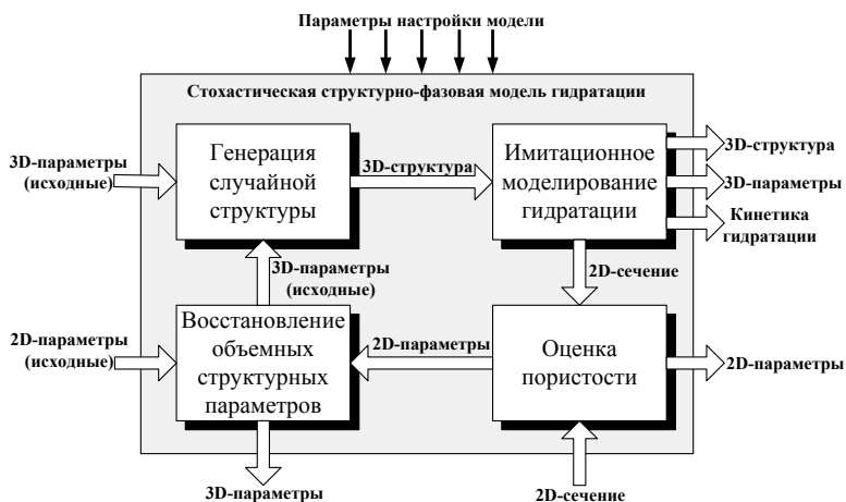
Рис. 1. Концепция моделирования гидратирующей цементной системы
