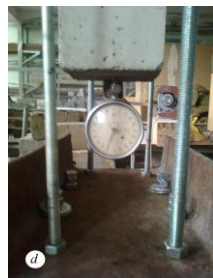
Рис. 2. Конструкція дослідних зразків та схема їх випробування: a – (серія 1) з розміщенням муфти всередині призми на кінці арматури; b – (серія 2) з розміщенням муфти на краю призми по напрямку дії сили висмикування; c – (серія 3) без муфти; d - випробування зразків на розривній гідравлічній машині
