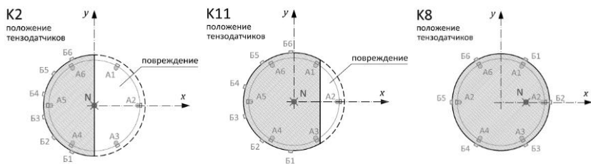
Рис. 1. Схема модели для испытаний с маркированным повреждением, положение тензодатчиков и внешние силы.
