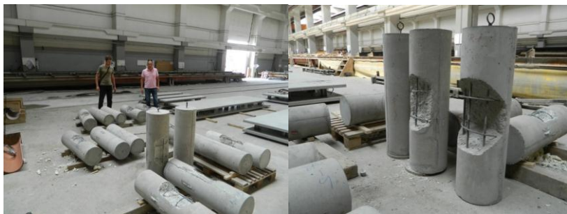
Рис. 2. Забетонированные экспериментальные модели.
