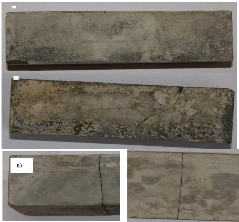
Рисунок 4 – Внешний вид образцов из цементного камня в возрасте 24 лет:
