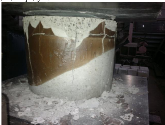
Рис. 1 . Испытание на кольцевую прочность
