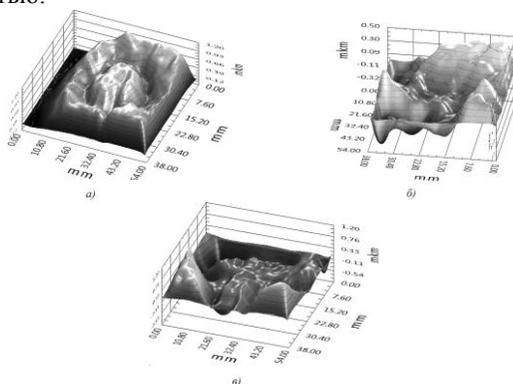
Рис.4. Деформации поверхности моделей структурных ячеек бетона а – с арматурой; б – с керамзитовым гравием; в – с низко модульным наполнителем
