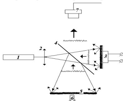
Рис. 2. Схема спекл-интерферометра.
