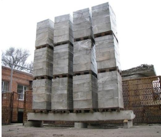
Рис. Вид плиты из фибропеножелезобетона при максимальной загрузке
