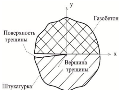
Рис. 6 Трещина в контактной зоне
