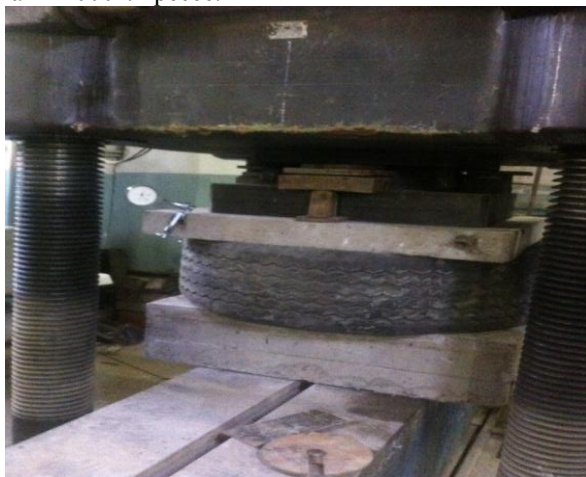
Рис. 2. Начальная стадия нагружения покрышки «Goodyear»
