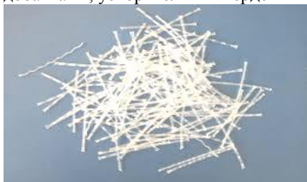
Рис.5. Внешний вид полипропиленовой фибры длиной 38мм
