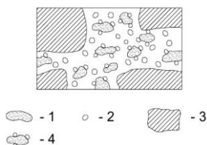
Рис. 3. Когуляционная структура полимерцементного штукатурного раствора
