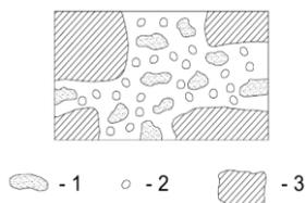
Рис.2. Структура полимерцементного штукатурного раствора после смешивания с водой
