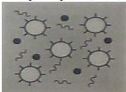
Рис. 1. Образование водной дисперсии полимеров из РПП
