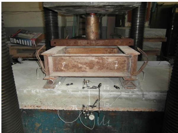
Рис.1 Схема передачи нагрузки и установки приборов
