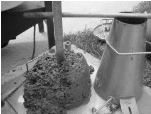
Рис. 2. Определение подвижности бетонной смеси по осадке конуса
