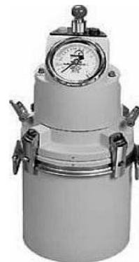
Рис. 3. Прибор TESTING DIN 1048 для определения количества воздуха находящегося в БС
