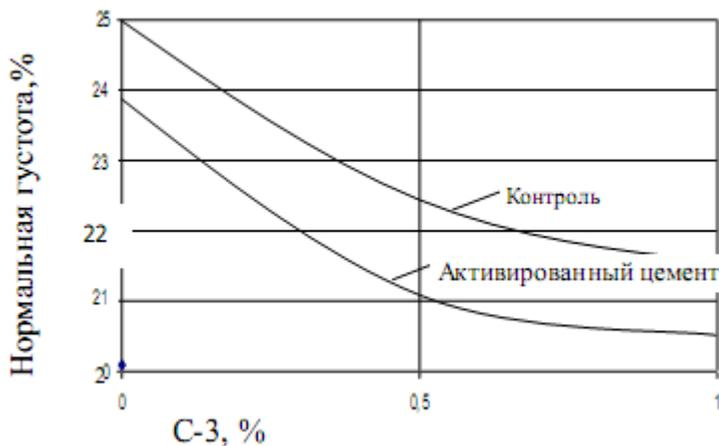
Рис. 1. Влияние содержания С-3 в портландцементе на нормальную плотность цементного теста
