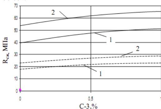
Рис.2. Влияние концентрации С-3 в вяжущем на  $R_{сжк}$  цементного камня
