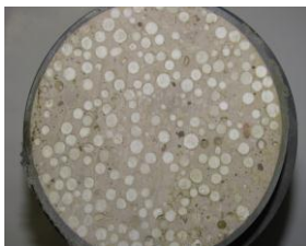
Рис.1. Сечение распила цилиндра с полистиролгипсобетонной смесью
