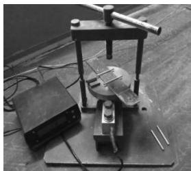
Рис. 4. Ручной пресс для испытания прочности образцов на изгиб
