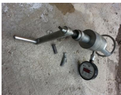
Рис.3. Определение прочности методом отрыва со скалыванием
