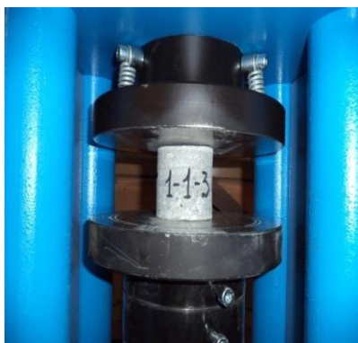
Рис. 1. Определение прочности бетона прямым испытанием образцов
