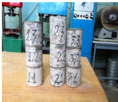
Рис.6. Керны, распиленные на образцы и подготовленные к испытаниям
