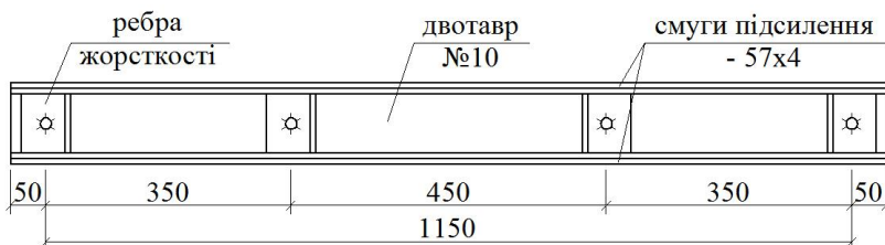
Рис. 1. Схема підсилених балок із експериментів І.Я.Донніка [3].
