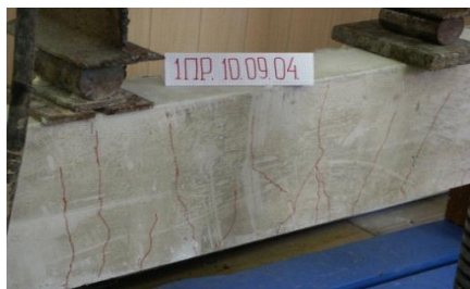
Фото 1 – Испытание фибропеножелезобетонной перемычки
