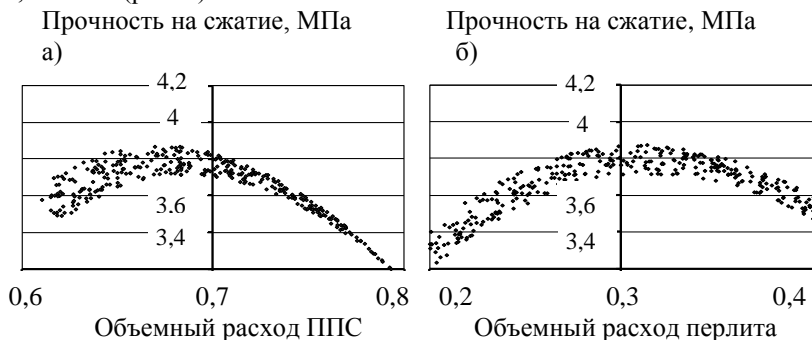
Рис.4. Зависимость прочности на сжатие ПСГБ от объемного расхода ППС – (а) и от объемного расхода перлита – (б)
