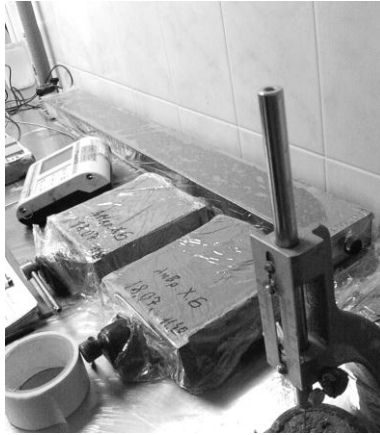
Рис. 1. Лінійка з пристроєм автоматичної реєстрації деформацій та форми з цементно-піщаним розчином
