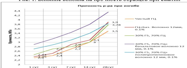
Рис. 2. Влияние волокна на прочность при изгибе
