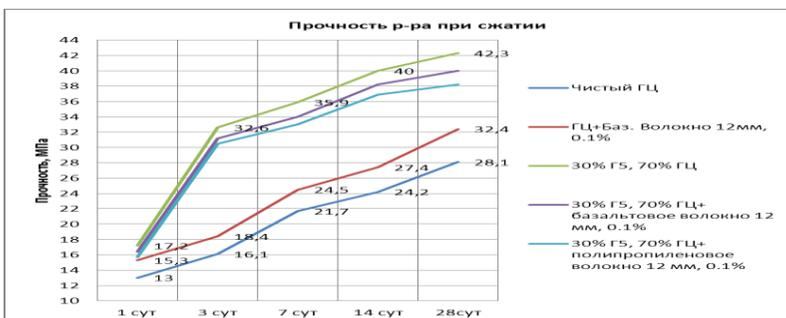
Рис. 1. Влияние волокна на прочность образцов при сжатии
