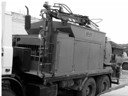
Рис.1 Машина ДН-011 для ямкового ремонту ( виробник Українське ДП "Нова техніка" )
