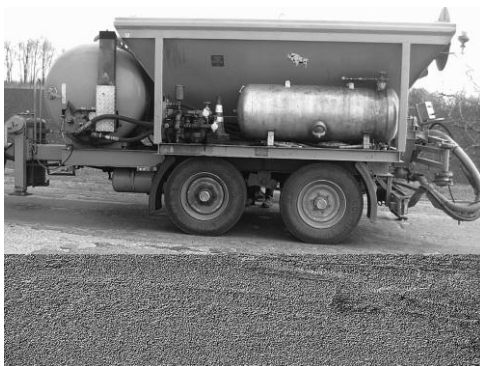
Рис. 2. Причіпна машина «SHAFER» для ямкового ремонту ( виробник фірма «Blau-Patcher», Німеччина)
