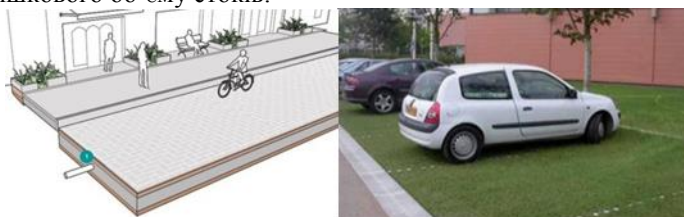
Рис. 1. Приклад влаштування водопроникних покриттів
