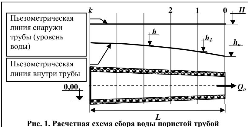
Рис. 1. Расчетная схема сбора воды пористой трубой
