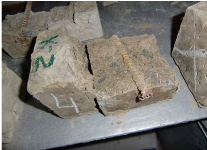
Фото 3 – Характер нарушения сцепления между фибробетоном и арматурой различной вещественной природы
