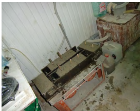
Фото 1 – образцы, подготовленные к уплотнению фибробетонной смеси
