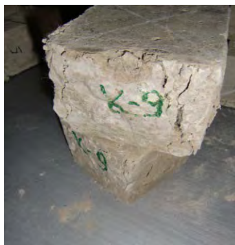
Фото 2 – разрушение фибробетона при сжатии
