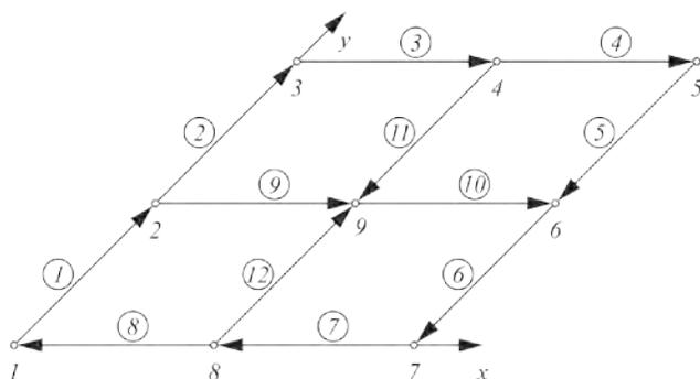
Рис. 2. Ориентированный граф плоской системы с перекрестными связями
