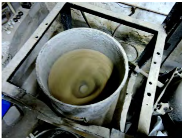
Рис. 1. Приготовление бетонных смесей в смесителе-активаторе роторного действия РС-06
