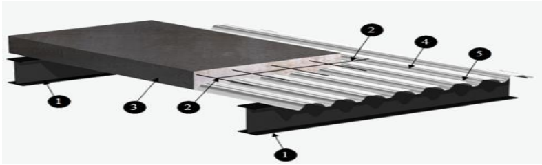
Рис. 2 – Переріз сталезалізобетонної плити по сталевому профнастилу (гладкий): 1 – прогон (основна несуча система будівлі); 2 - арматура (вторинна несуча система); 3 – бетон (вторинна несуча система); 4 – профнастил ТП-60 (допоміжна несуча система; основний код ТПК – 02); 5 – шуруп нефарбований (кріплення профнастилу ТП-60 до балок перекриття; основний код ТПК – 14)
