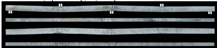
Рис. 3. Характер розвитку тріщин та руйнування балок
