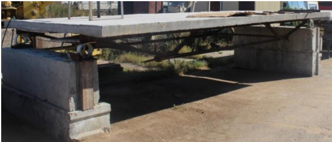
Рис. 2. Просторова сталезалізобетонна комбінована попередньо-напружена шпрингельна конструкція
