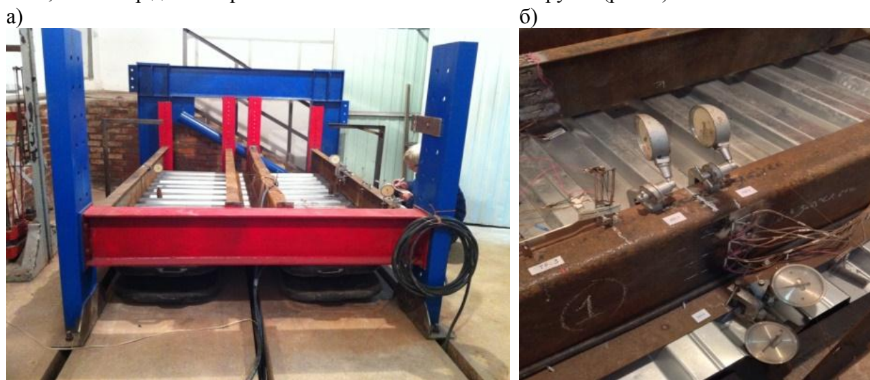
Рис. 1. Стендовые силовые испытания балок–образцов с коррозионными повреждениями: а – опорные конструкции и пневматическая система нагружения; б – контроль параметров НДС образца Б-4
