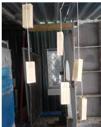
Рис. 1. Проведення кліматичних випробувань зразків деревини
