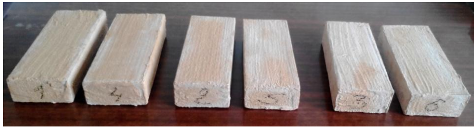
Рис. 7. Вигляд зразків після 7 циклів випробувань за експрес-методом з вмістом КФС у геоцементному покритті 1, 4 – 10%; 2, 5 – 20%; 3, 6 – 40%
