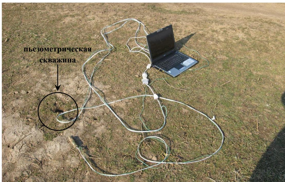
Рис. 2. Измерение температуры воды в пьезометрической скважине
