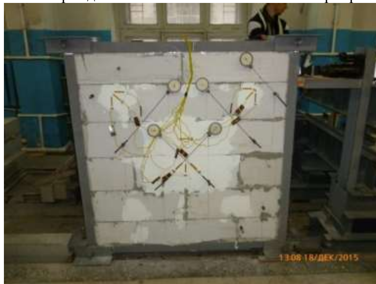
Рис. 1. Стальная шарнирная рама для испытательного образца
