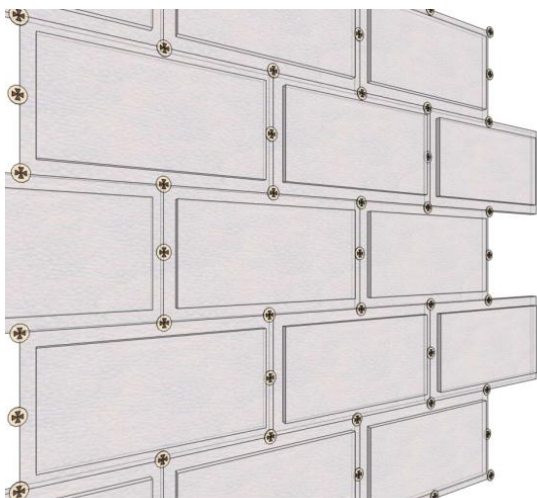
Рис. 3. Технологічна схема розташування дюбелів (6 шт/м 2 )
