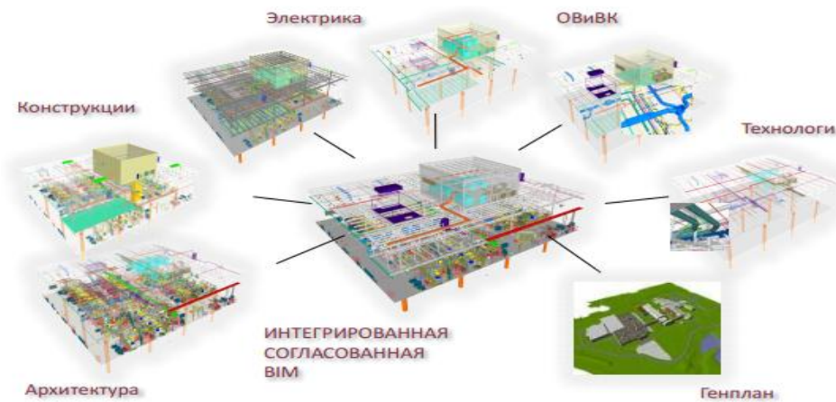
Рис. 1. Организационная схема взаимодействия в технологии BIM
