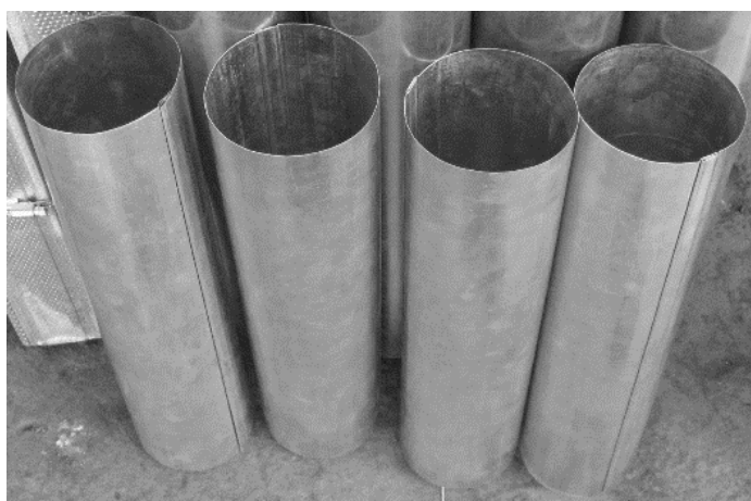
Рис. 1. Трубні елементи з одиночним фальцем, які потребують підсилення фальцевого з'єднання
