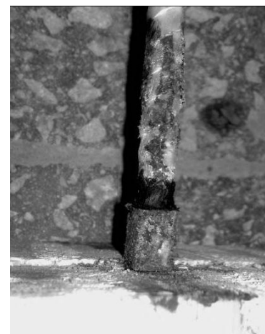
Рис. 3. Вигляд зразка зі склопластиковою арматурою після випробувань: а – загальний вигляд; б – вигляд висмикнутої арматури
