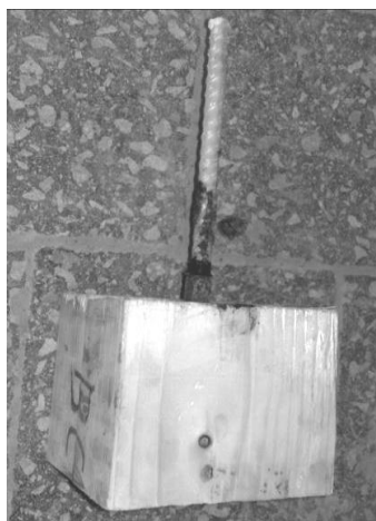
Рис. 3. Вигляд зразка зі склопластиковою арматурою після випробувань: а – загальний вигляд; б – вигляд висмикнутої арматури
