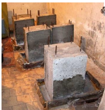
Рис. 1. Заволожені бетонні зразки
